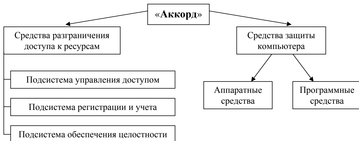
Рисунок 4.2 - программно-аппаратный комплекс средств защиты компьютерной информации от несанкционированного доступа «Аккорд»
