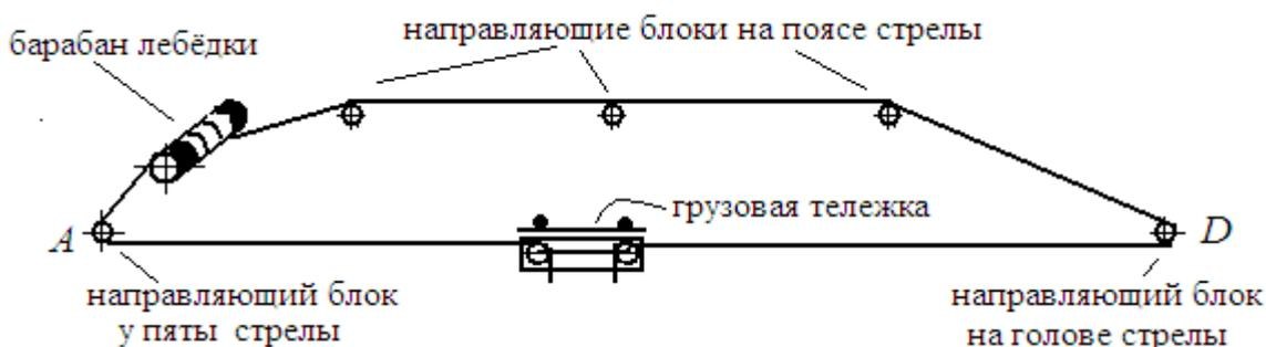
Рис.1.9. Схема запасовки каната механизма перемещения грузовой тележки
