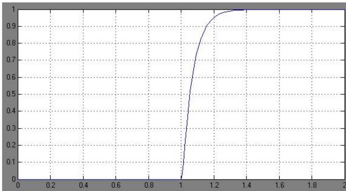
Рис.6.24. Переходный процесс системы с модальным регулятором в Simulink MATLAB.
