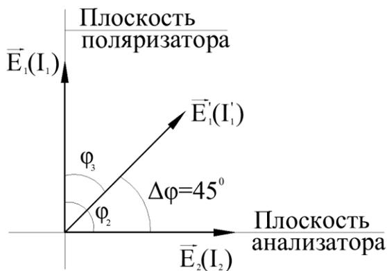
**Рисунок 24. Ориентация  $\vec{E}$  световой волны относительно плоскостей поляризатора и анализатора**
